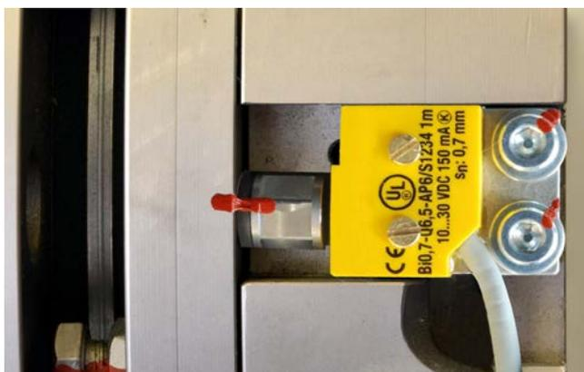
Бесконтактная система контроля срабатывания тормоза с индуктивным датчиком присутствия
